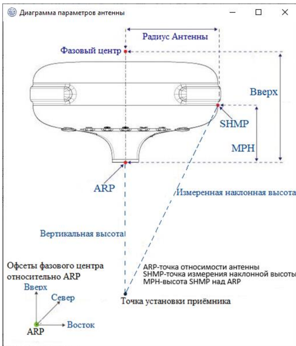
Рисунок 200 – Схема геометрии параметров антенны
